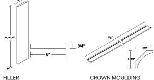
6 x <sup>3</sup>/<sub>4</sub> x 30" | F630 6 x <sup>3</sup>/<sub>4</sub> x **36**" | F636 6 x <sup>3</sup>/<sub>4</sub> x 42" | F642
